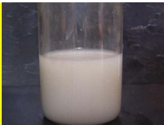
Образование коллоидной серы при действии гипохлорита на раствор \text{Na}_2\text{S} фото В.Н. Витер
